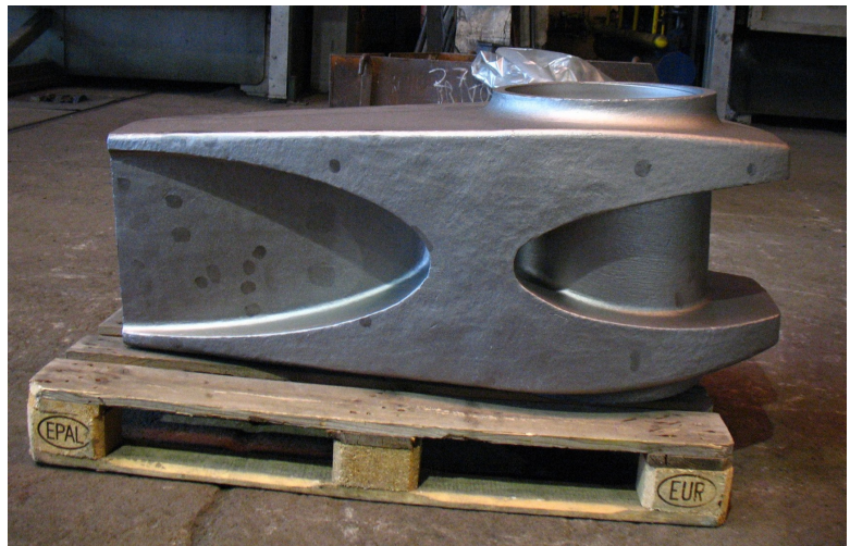
Obr. 6b - Hlavice - odlitek
