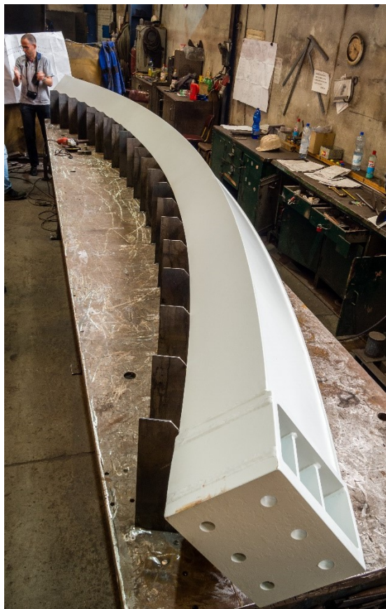
Obr. 9 Kontrola vzorku dílce OK
